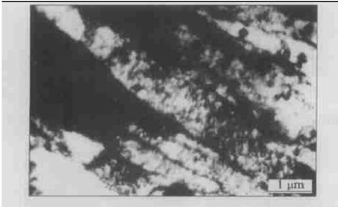
Fig. 4 TEM morphology of lath martensite
