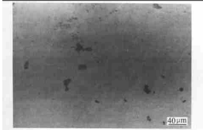
Fig. 1 BEI photograph of arc-melted Al 72 Ni 12 Co 16 alloy
